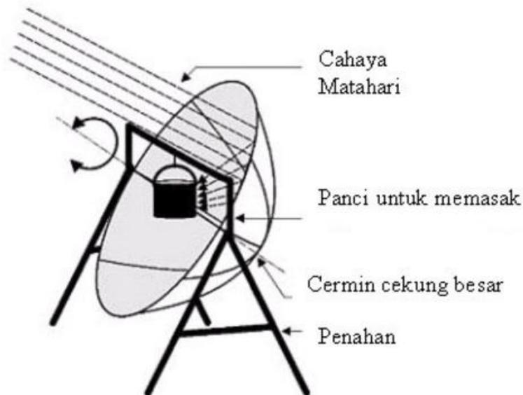
**Gambar 2.** Rangkaian alat kompor surya sederhana
